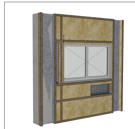
3- Principe de montage du panneau : - voile travaillant en Fermacell 15mm finition arrière peinte, permettant de s'affranchir des bords du panneau béton existant; - ossature bois par montants et traverses 60x200mm et remplissage ouate de cellulose (ou autre à confirmer) - gaines de ventilation latérales (soufflage et reprise) insérées dans l'épaisseur de 200mm de l'ossature - réservation basse partielle dans l'emprise de l'ancienne allège vitrée pour placer la grille de reprise - réservation latérale dans l'emprise partielle de l'ancien châssis principal pour placer le soufflage : position plus haute que la reprise pour éviter l'inconfort d'un courant d'air.
