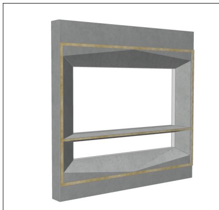
2 - Bande laine de roche 60x20mm ép. en jonction entre panneau existant et panneau neuf pour assurer : - rupture feu et phonique entre panneaux - étanchéité à l'air - reprise d'aplomb. NB : pour la facilité de lecture des dessins, les châssis existants ne sont plus représentés. Dans la chronologie réelle, ils ne seront déposés qu'à la fin.
