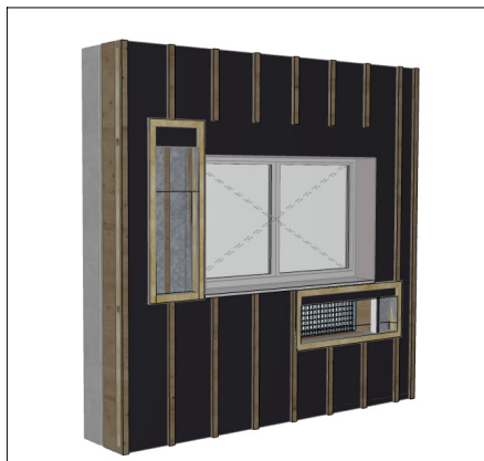
4 - Fermeture du panneau : - osb 15mm fixé sur l'ossature 60x200mm pour fermer les caissons isolés - laine de roche 60mm placé sur l'osb : isolation complémentaire et protection feu - lattage horizontal 60x60mm + contre-lattage 60x60mm + pare-pluie - réservation et chevêtres pour pose en saillie des raccords de ventilation entre les gaines verticales de ventilation et les grilles de soufflage et reprise
